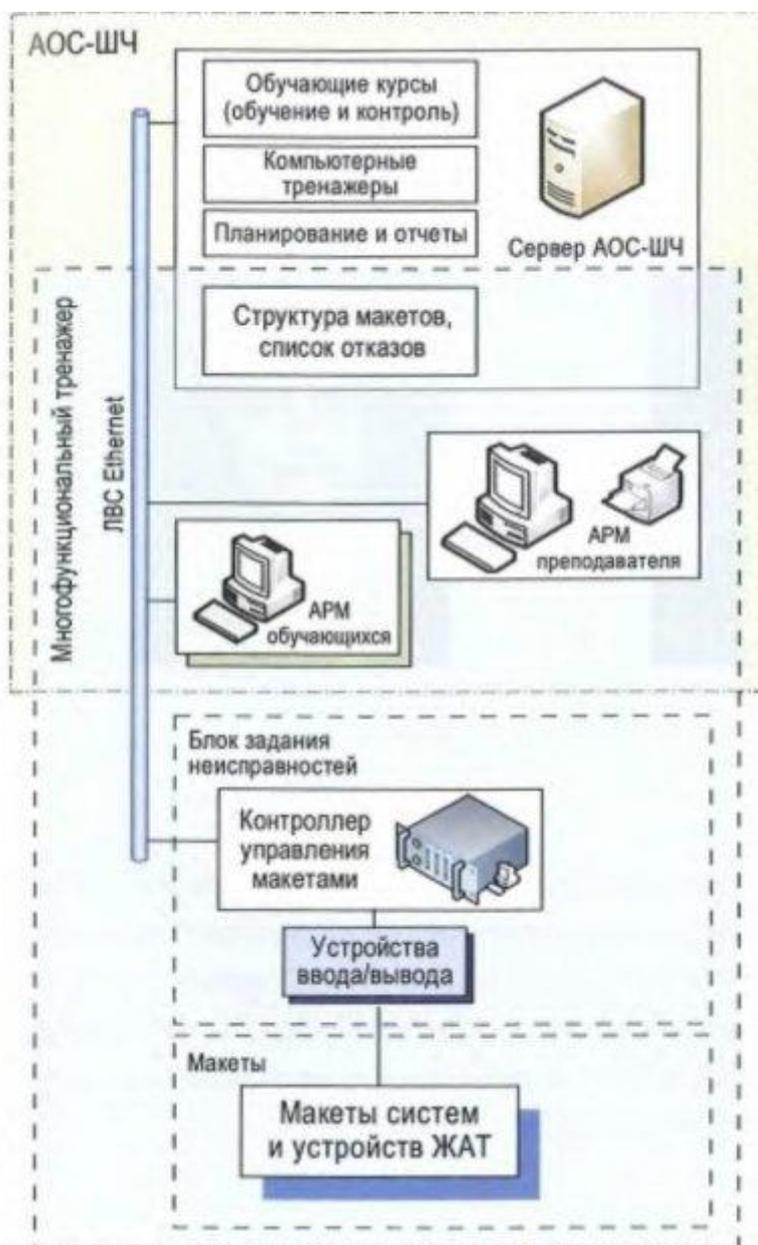
В интегрированный программно-аппаратный комплекс входят: компьютерный класс с автоматизированной обучающей системой АОС-LU4, действующие макеты устройств (БМРЦ, стрелка с пятипроводной схемой управления, схема управления светофором, тональная рельсовая цепь), блок задания неисправностей (БЗН), который реализует сопряжение АОС-ШЧ и макетов и управление ими.
