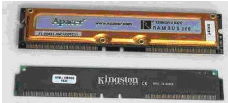
Рис 4 Модули памяти RIMM
