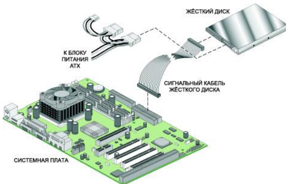
Рис. 7 Подключение жёсткого диска к материнской плате
