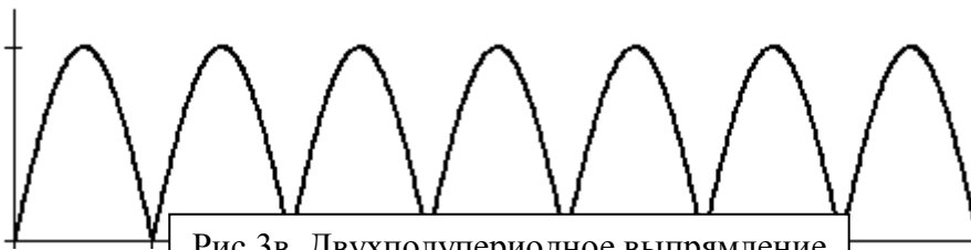
Рис 3в Двухполупериодное выпрямление
