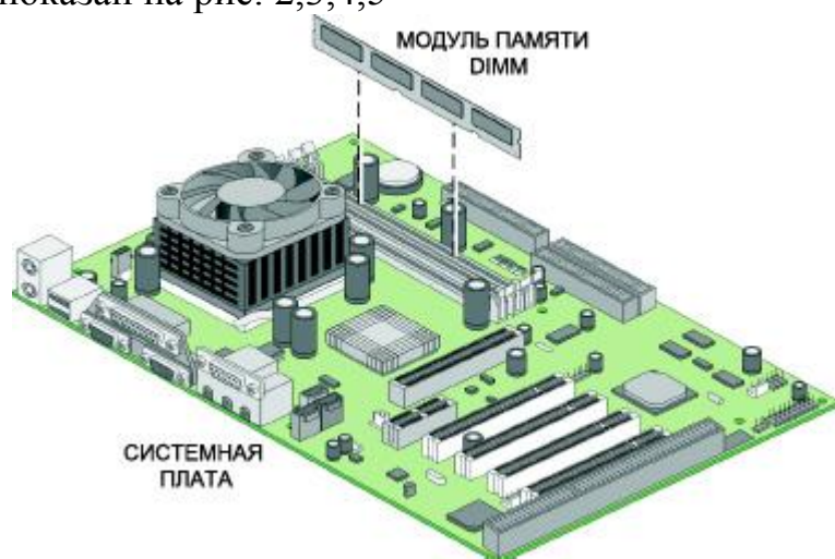
Рис.2 Установка модуля памяти в материнскую плату
