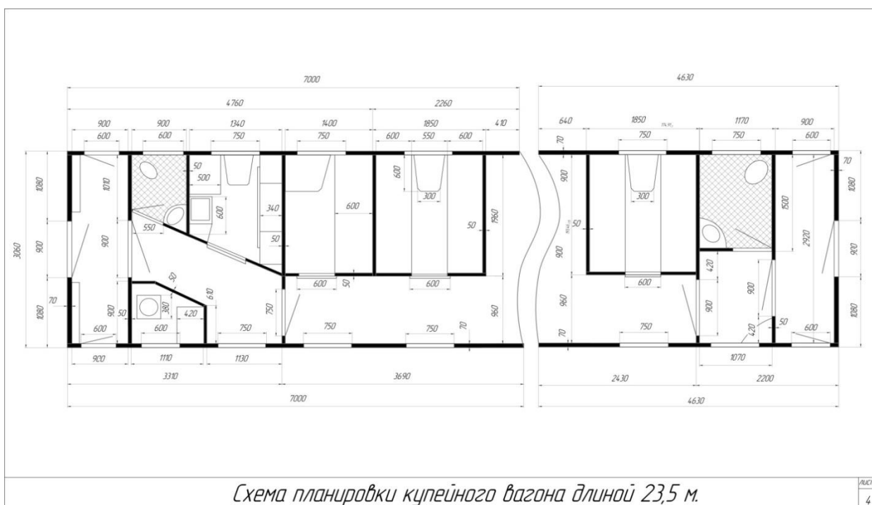
Схема 1 Расположение оборудования в кузове купейного вагона.
