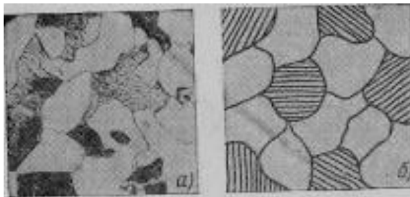
Рис. 13. Доэвтектоидная сталь с 0,3 % углерода – феррит + перлит: а - микроструктура (x500) б - схема микроструктуры
