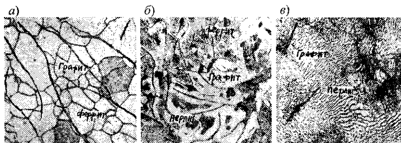
24. Структуры серого чугуна: а - ферритного; б - феррито-перлитного; в - перлитного
