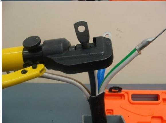
7. Опрессовать наконечник. Снять опрессовочное устройство. Проверить правильность опрессования наконечника.
