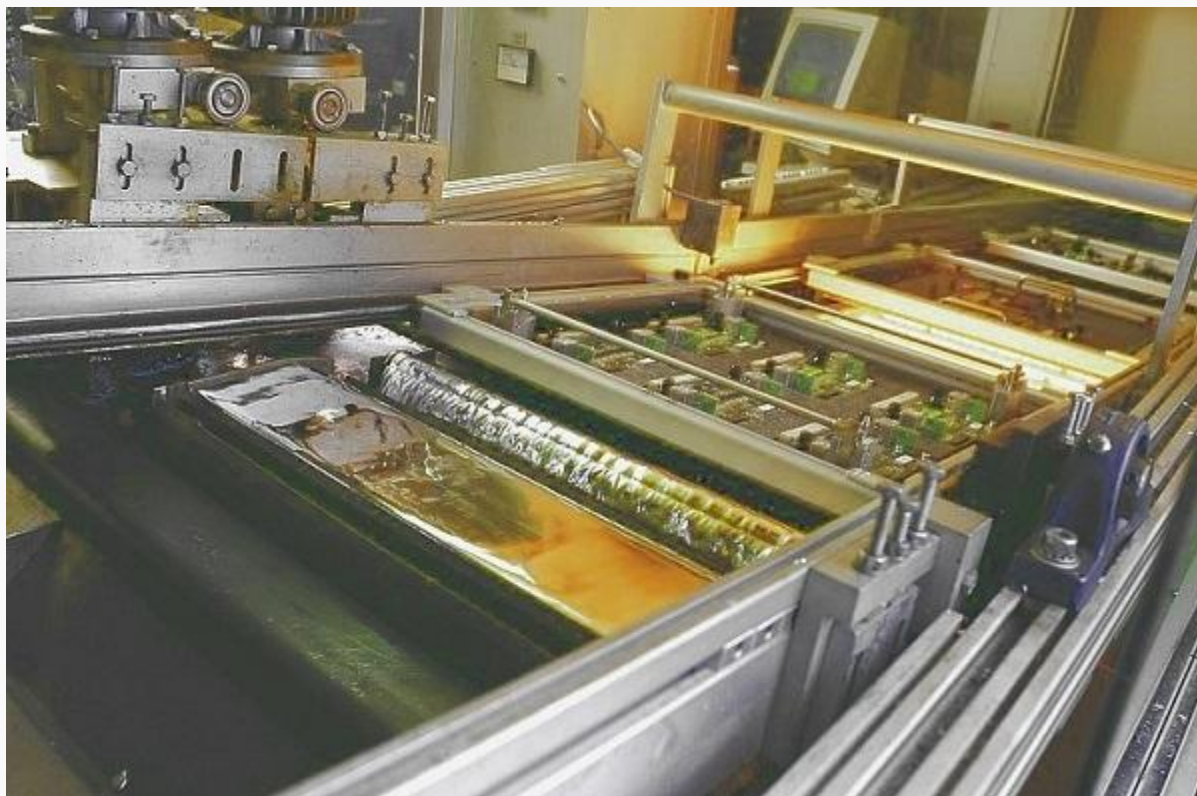
Установка пайки волной.
