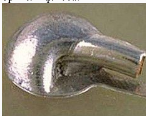
Плохое смачивание припоем выводом компонента.
