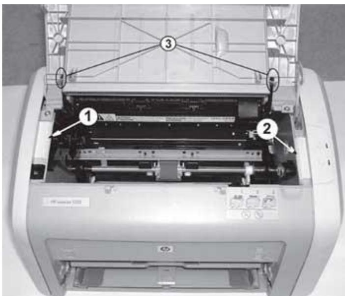
Рис. 4. Защёлки на верхней части крышки
