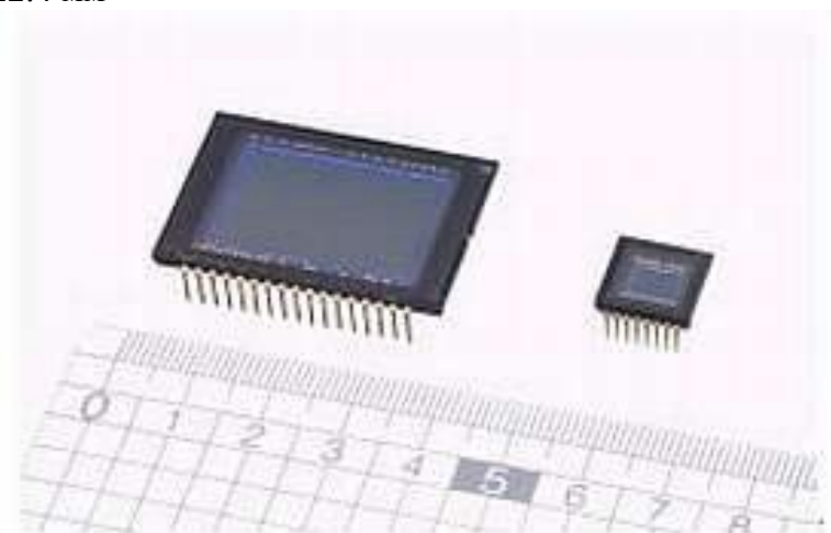
Рис 3 Структура цветных фильтров матрицы Матрица фирмы Sony на 6 миллионов пикселей показана на рис. 4 . Размер по диагонали- 22.4 мм
