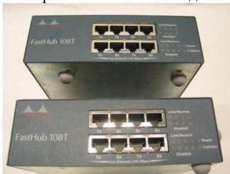
Концентратор Cisco Fasthub 108T
